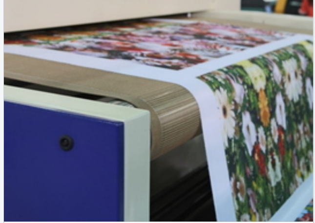
حزام تيفلون داخل ماكينة طباعة/تلييس حراري صناعية
